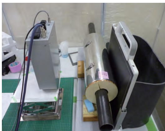
附着保温材的配管检测实例
