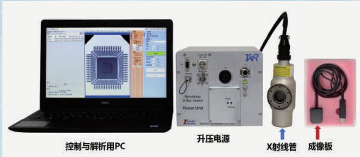
微焦点小型X射线检测仪与超小型高精度数字成像板构成超高精度检测系统
