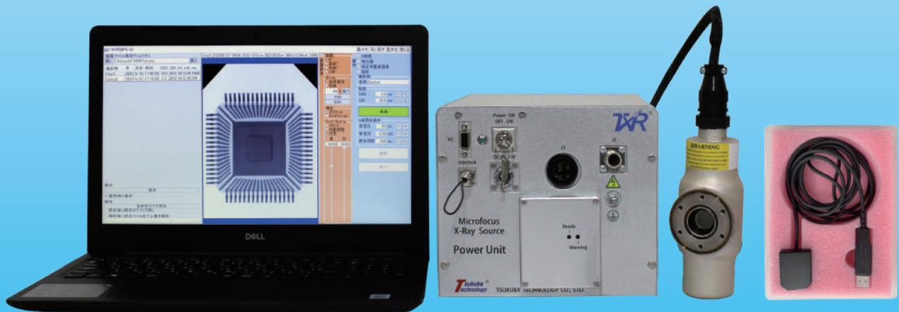
微焦点X射线管、专用电源、高精度数字成像板与计算机构成检测系统
