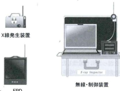
第1図 小型X線検査装置構成図
