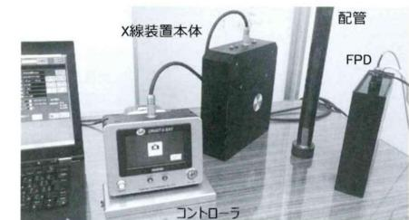
写真2 開発した小型X線検査装置
