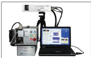
レーザー超音波可視化検査装置
