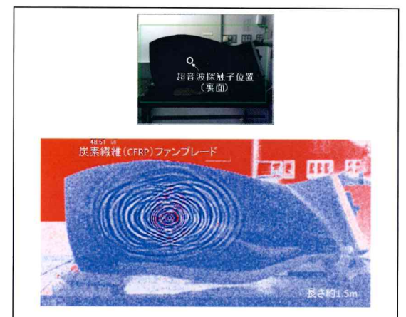
図5 CFRPファンブレード(B777)の超音波伝搬画像例
