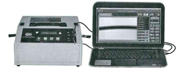
写真7 装置の電線検査風景
