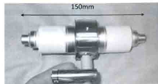
写真2 針葉樹型カーボンナノ構造体冷陰極電子源を搭載した小型X線管
