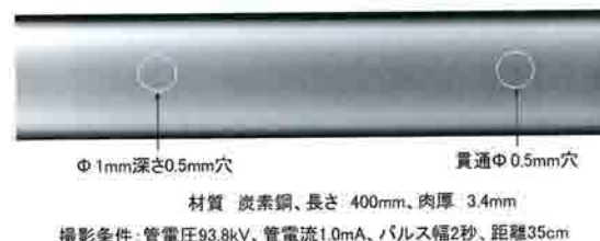
第3図 配管の撮影画像例
