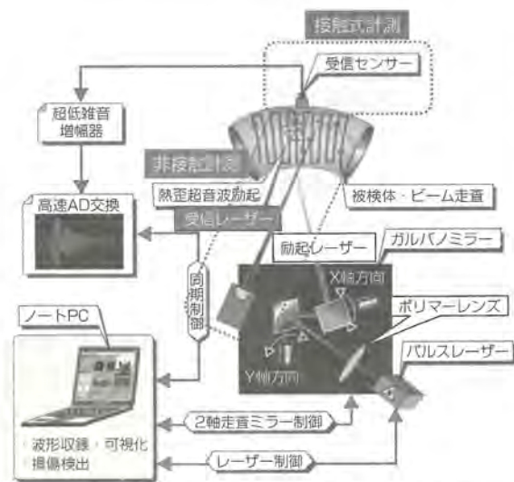
第2図 レーザ超音波可視化検査装置 (LUVI) の構成図
