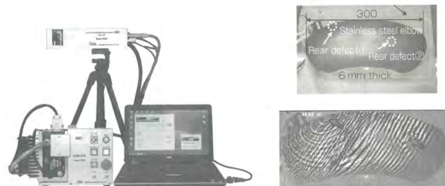
第1図 レーザー超音波可視化検査装置と可視化画像例(2つの矢印部に模擬欠陥有り)
