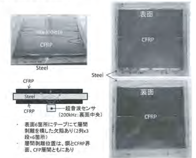
図6 CFRP接着鋼板
