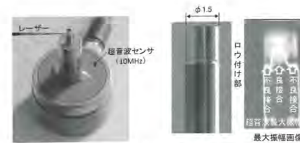
図11 工具ろう付け部接着不良
