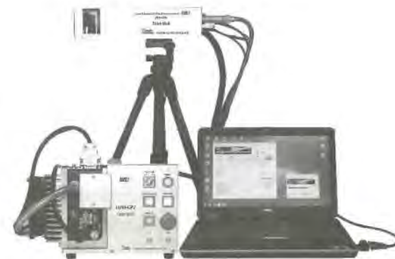
第2図 レーザー超音波可視化検査装置 (LUVI)
