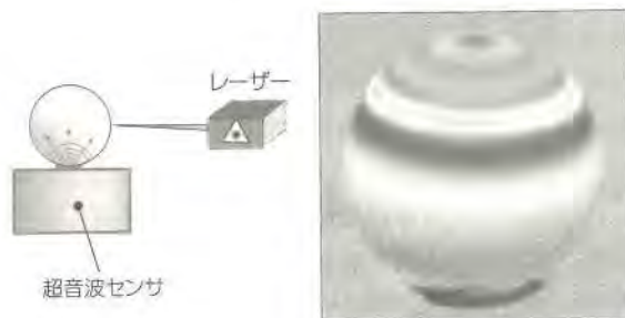
第6図 ベアリング玉の検査
