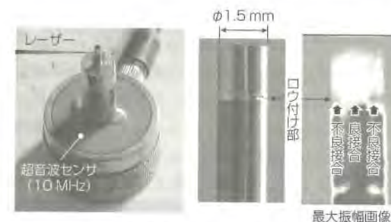
第9図 工具ろう付け部の接着不良検査
