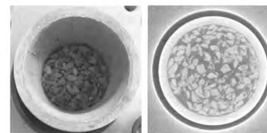
(a) 実物 (b) CT画像 第3図 \Phi 5cm砂礫コアの実物とCT画像 (被写体:アルミニウム製パイプ、外形66mm、肉厚5mm、 2~5mmの礫粒子)
