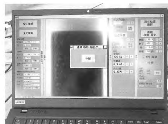
写真6 360度CT撮影ソフト <撮影条件>管電圧:120kV、管電流:0.9mA、パルス幅:0.3s、 周期:10秒、距離:14cm
