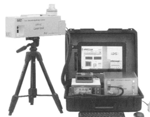
図3 レーザー超音波可視化検査装置 (LUVI-LC)
