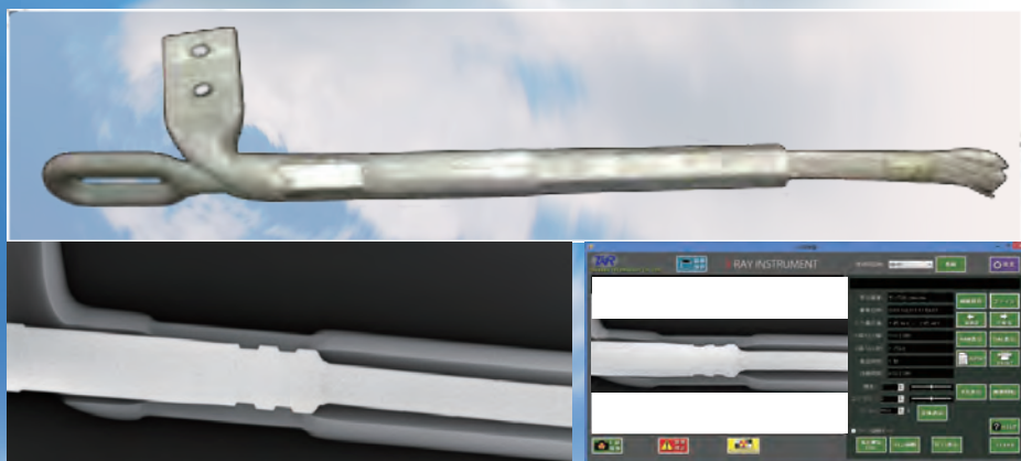
高压耐张线夹检测
