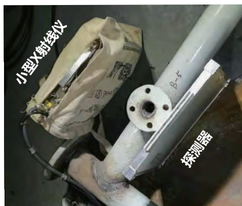
输油配管内部检测实例
