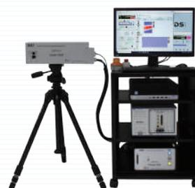
新レーザー超音波可視化検査装置
