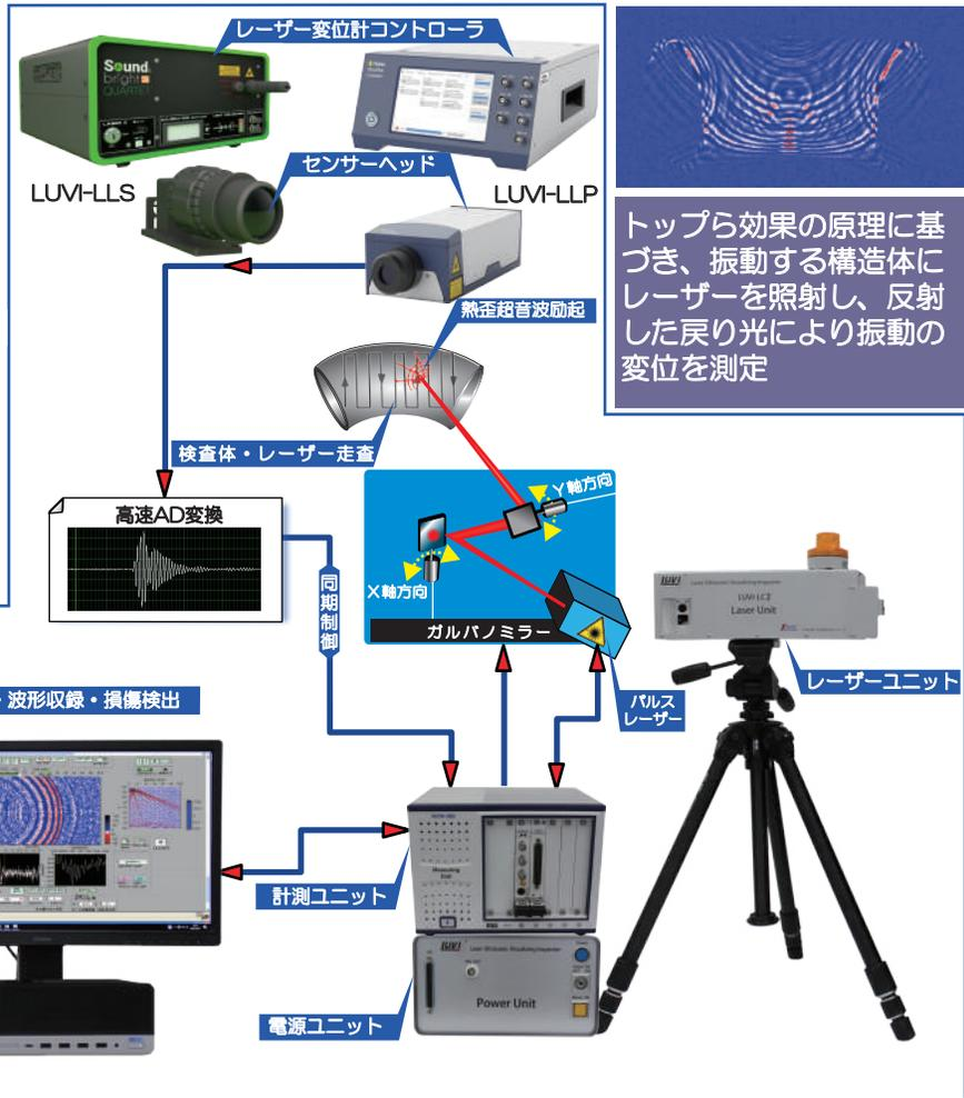
トップら効果の原理に基づき、振動する構造体にレーザーを照射し、反射した戻り光により振動の変位を測定
