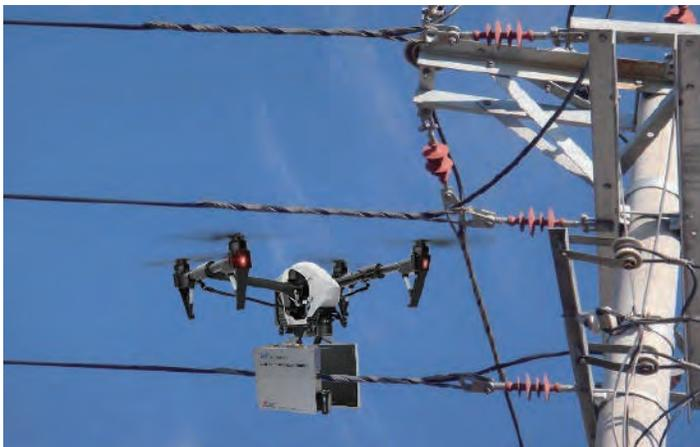
远程操控，无人机搭载，实时观察检测结果
