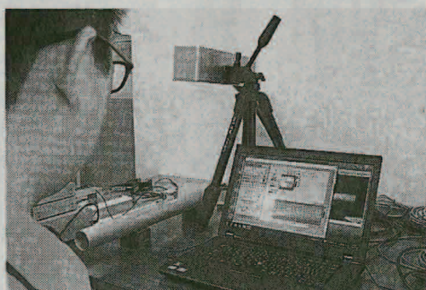
レーザーをパイプに照射すると、パソコンに超音波の動画が映る
