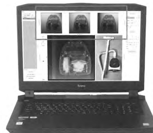
写真6 掃除機の断層撮影画面 (撮影条件：管電圧150kV、管電流0.4mA、パルス幅1s、距離50cm)
