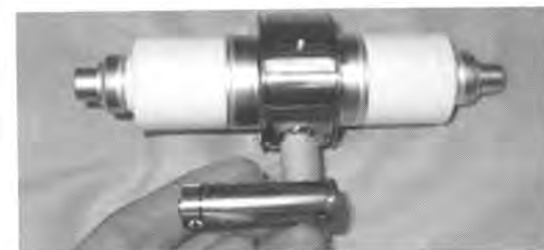
写真2 カarbonナノ構造体電子源を搭載した冷陰極X線管
